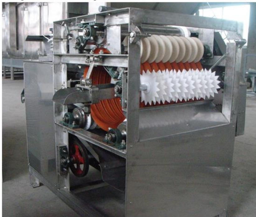
Рис. 2. Загальний вид луцильної машини для бобових культур
