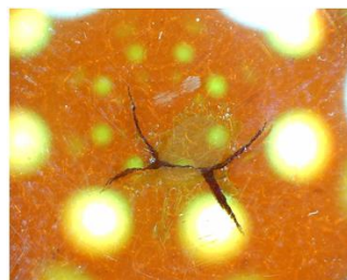
г) – фрагмент лінзи зі слідами термічного пошкодження
