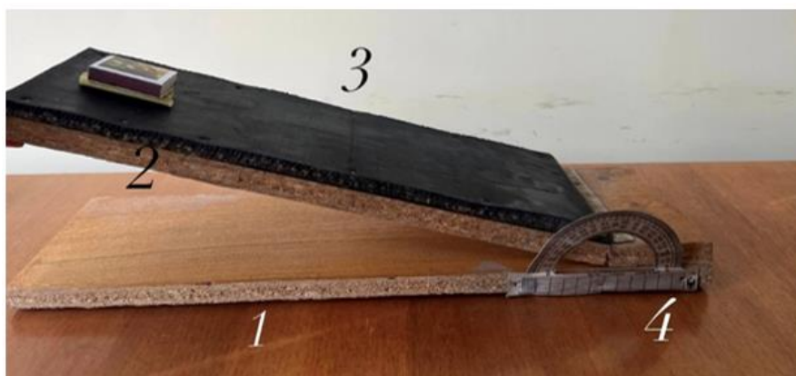
Рис. 1. Прилад «похила площина»
