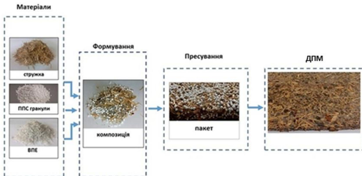
Рисунок 1. Процес формування ДПМ зниженої щільності [3]
