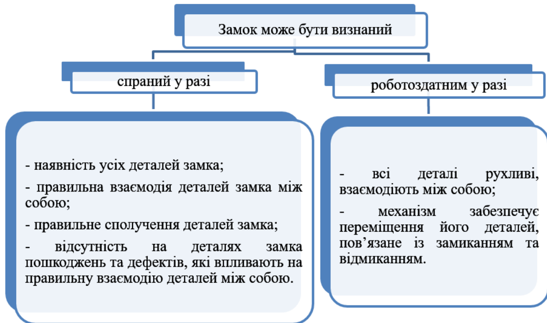
Рис. 1. Критерії оцінки справності та роботоздатності механізму замка
