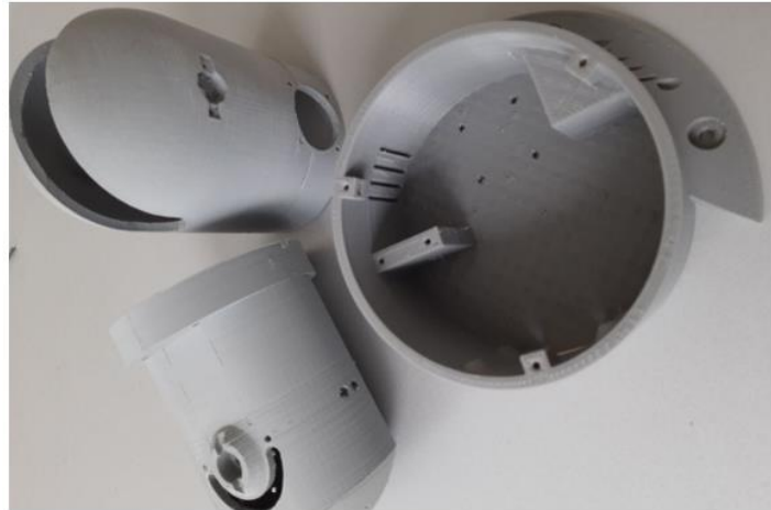
Рис. 2. Деталі корпусу маніпулятора виготовлені методом 3D друку
