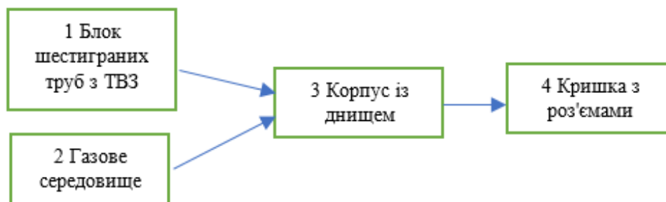
Рис. 4. Функціональна структурна схема багатомісної герметичної корзини (БГК)
