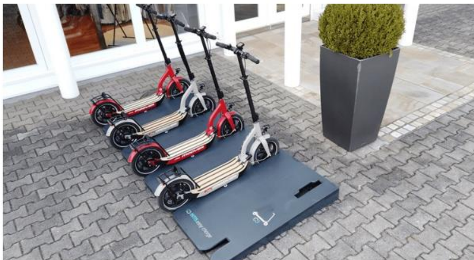
Рис. 3. Індукційна (бездротова) зарядка для електричних електросамокатів
